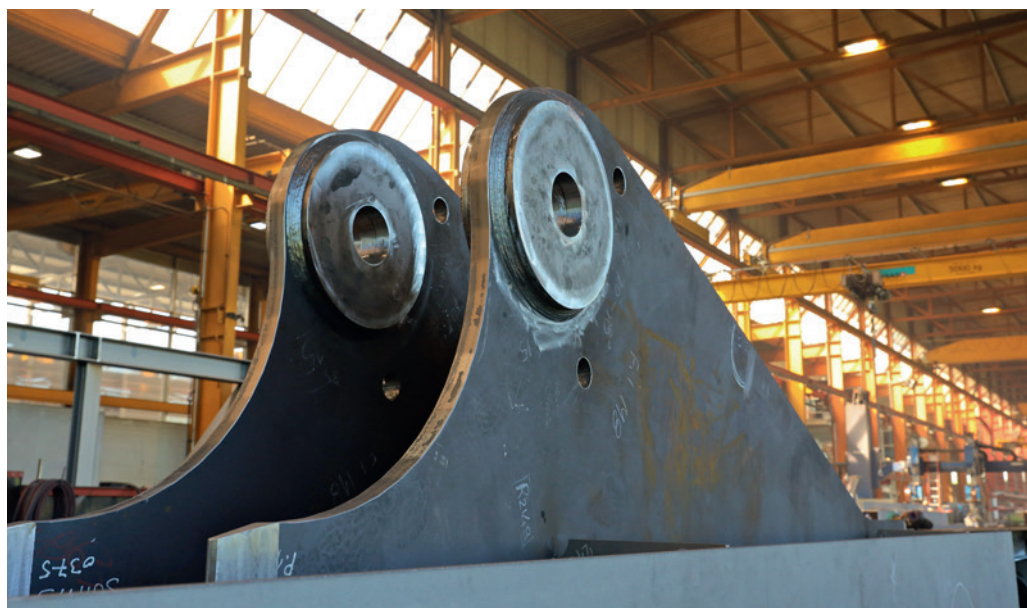
Ancrages des haubans dans le tablier
