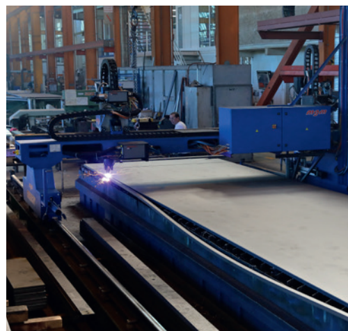
Découpage des tôles (débitage par oxycoupage)
