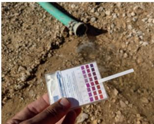
Analyse du pH de l'eau, rendue alcaline au contact des bétons
